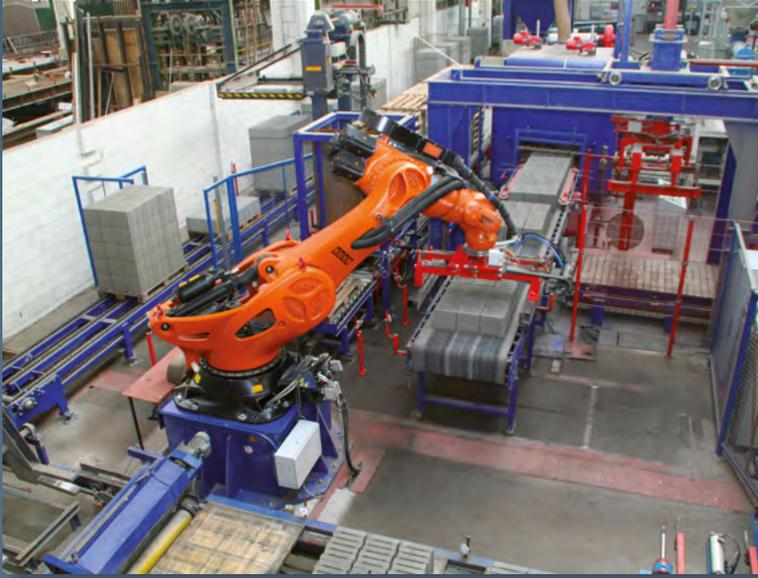
Roboter Handling System für Steingut
