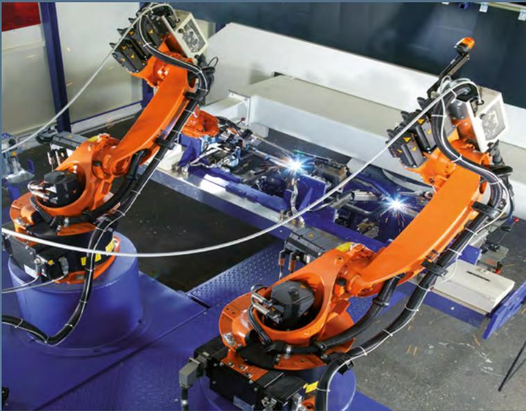
Roboterschweißanlage für Industrieteile
