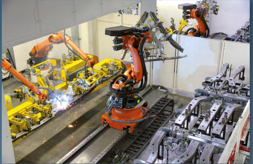
Roboterschweiß- und Handling System für Achsträger- Nutzfahrzeuge
